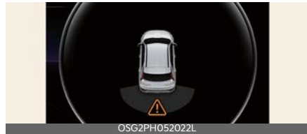
A: Ultrasonic sensor error or blockage
